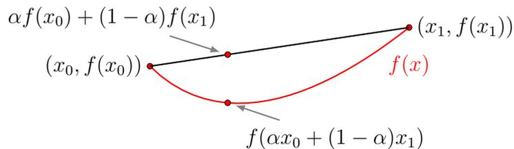
Abbildung 3.6: Die Funktion  $f(x)$  ist konvex.
