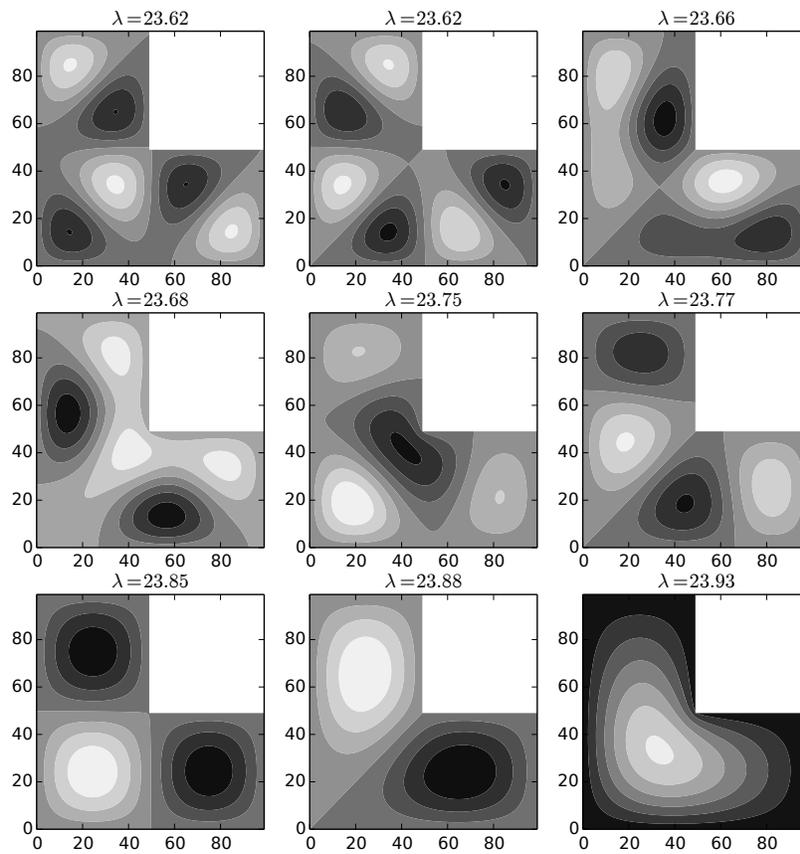
Abbildung 5.8: Eigenfunktionen eines dünnen, L-förmigen Bleches
